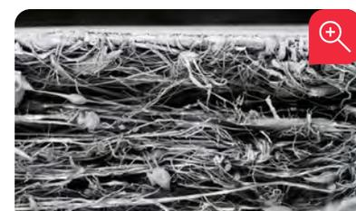
R.T.R.+ Membrane Querschnitt (stark vergrößert)
